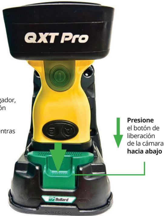
Cuando se haya verificado la conexión y la batería se esté cargando, el botón de encendido de la cámara parpadeará en VERDE (en los nuevos modelos) o en ROJO (en los modelos más antiguos). Una vez cargado completamente, el botón de encendido se iluminará en VERDE fijo.
