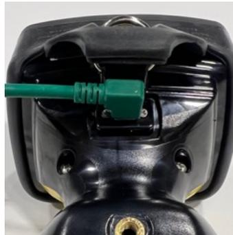
Si el software de control interno de la Bullard XT determina que las temperaturas internas son demasiado altas o bajas para cargar la batería, el botón de encendido/apagado parpadeará en NARANJA/ROJO hasta que la temperatura interna de la cámara se establezca en un rango apropiado para la carga. Continuará cargándose automáticamente cuando se alcance una temperatura moderada.
