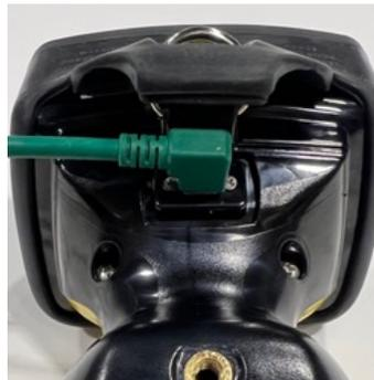
Si el software de control interno de la Bullard XT determina que las temperaturas internas son demasiado altas o bajas para cargar la batería, el botón de encendido/apagado parpadeará en NARANJA/ROJO hasta que la temperatura interna de la cámara se estabilice en un rango apropiado para la carga. Continuará cargándose automáticamente cuando se alcance una temperatura moderada.
