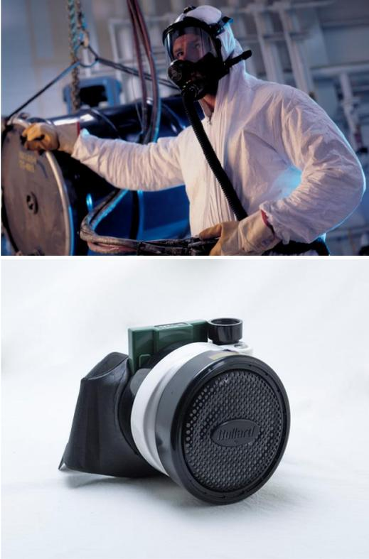
EVA强制送风呼吸器是以最新的尖端科技设计而成。EVA的设计紧贴用户和专家的需求，技术和理念机身小巧纤薄，配带舒适，还能提供高达 1000 的保护系数 (Assigned Protection Factor)。创新的自动流控技术系统 (Active Flow Technology System™)能自动因应使用者的呼吸量而调节供气量。这智能系统能自动识别不同的滤罐、头罩、滤罐负荷和电池容量而保持恒常的供气量。EVA配备电量表，简易清楚，让使用者能迅速检查电池状态。风机的无刷马达，使用寿命长达 10,000小时，耐用可靠。
